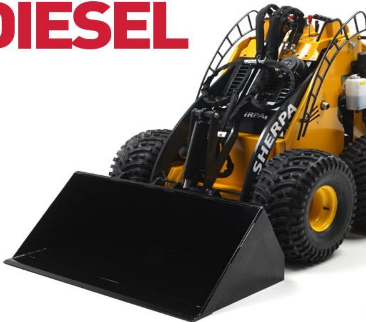
Использование гидравлического привода для 4WD постоянного полного привода на 4 колеса, и для привода навесного оборудования. Это делает SHERPA 100 Diesel доступным в различных отраслях промышленности.
