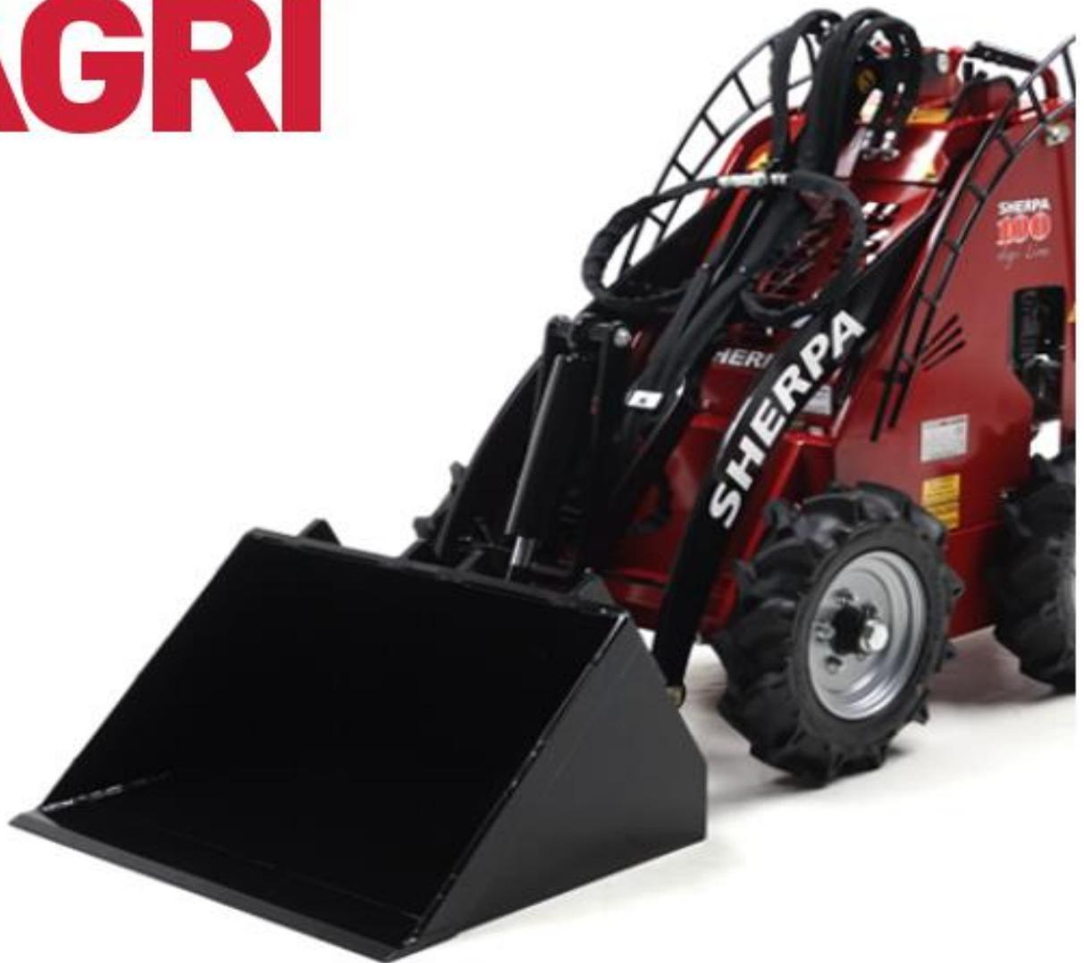
Благодаря ширине всего 76 см, SHERPA 100 Agri-Line может проходить через узкие проходы. Это делает его идеальной машиной для работы на мини-фермах и в конюшне. SHERPA 100 Agri-line - это долгожданная помощь для работ по перемещению соломы и корма.
